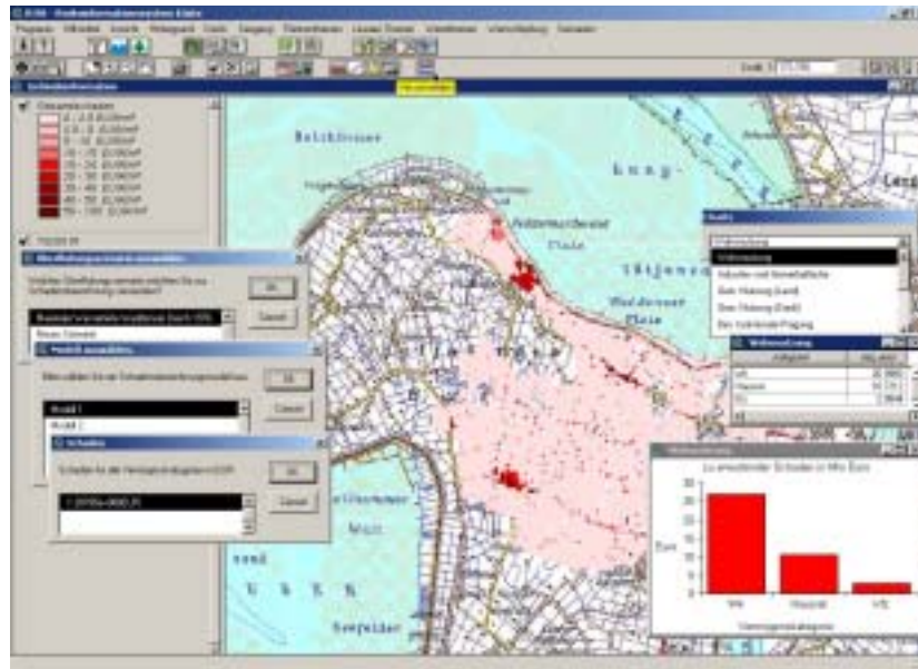
Abbildung R-10: RISK – Schadensberechnung für verschiedene Sätze von Schadensfunktionen
