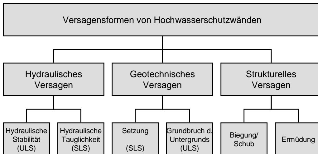
Abbildung 3-18: Hauptversagensmechanismen von Hochwasserschutzwänden [vgl. OUMERACI ET AL., 2001].
