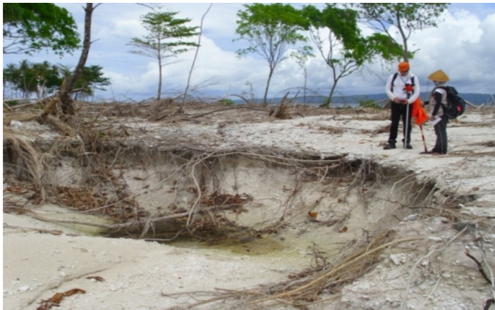
Gambar 18. Pengerukan akibat tsunami di Pulau Libuat, Pagai Selatan Foto: GITST.
