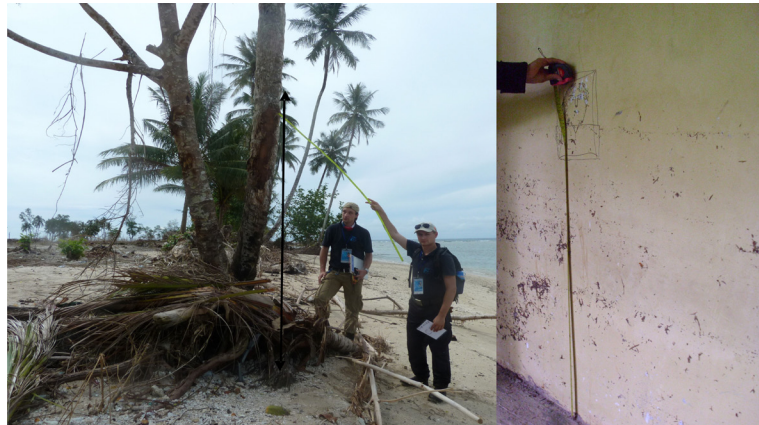
Gambar 11. Indikasi ketinggian genangan ( flow depth ) berupa goresan pada batang pohon, kiri, dan jejak genangan air pada dinding bangunan, kanan. Foto: GITST.
