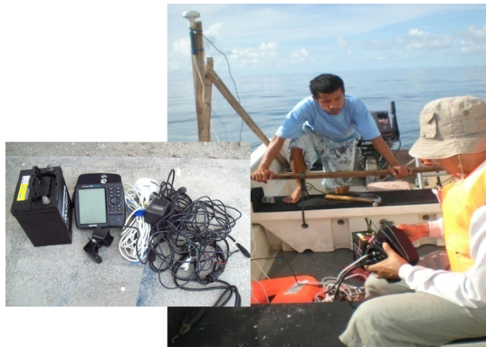
Gambar 9. Seperangkat alat pengukur kedalaman dasar laut ( echosounder ) dan pemasangan alat di perahu. Foto: GITST.
