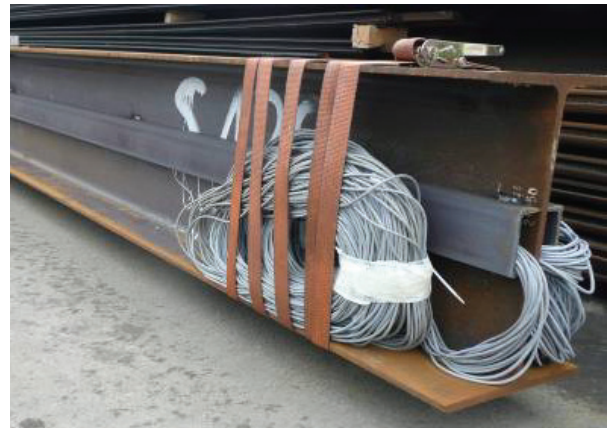
Abb. 13: applizierter DMS, wasserdichter Verschluss [BRUNS et al., 2011] und Einhausung
