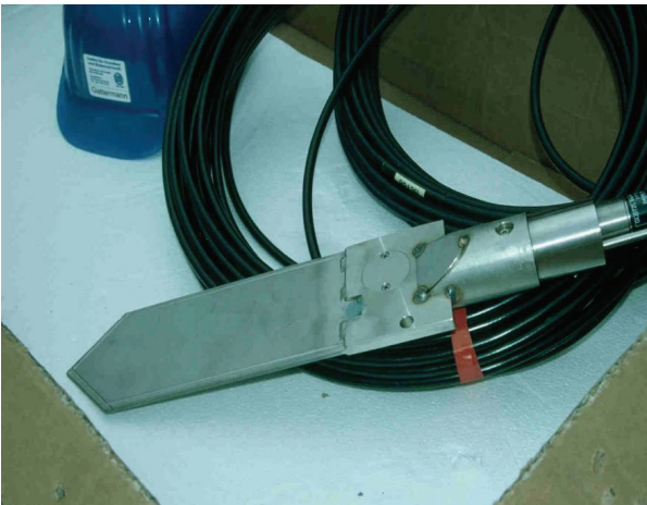
Abb. 8: Einpressbarer kombinierter Spannungsgeber [GATTERMANN et al., 2010]
