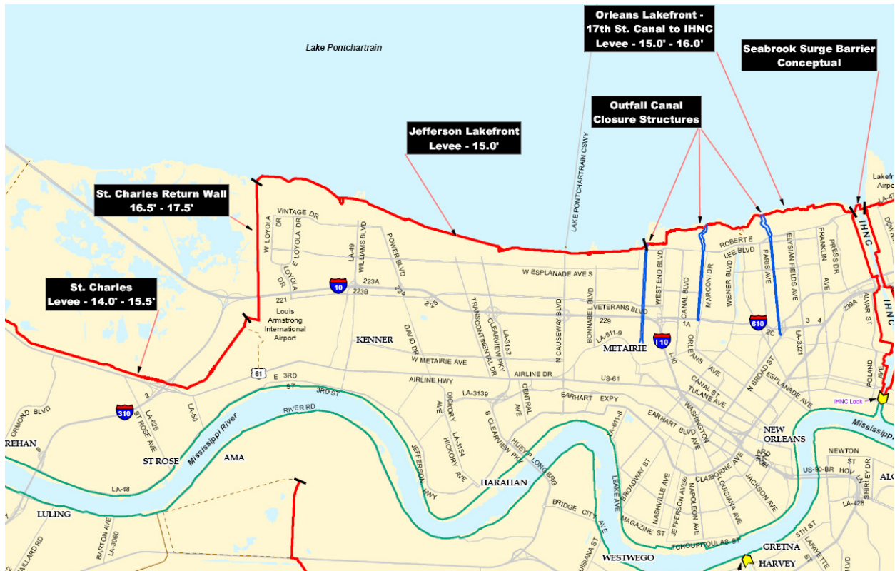
Abb. D - 2: Darstellung des “Greater New Orleans Hurricane and Storm Damage Risk Reduction System (HSDRRS)” zur Vermeidung bzw. Minimierung von Sturmflutrisiken [WWW.MVN.USACE.ARMY.MIL, 2008]
