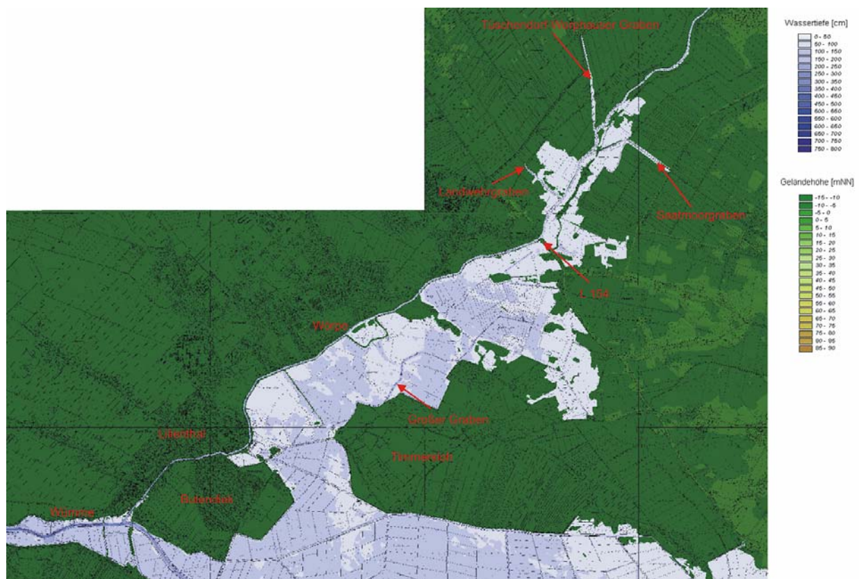
Abbildung 8-14: Überschwemmungsgebiete im Bereich der Wörpe bei einem HQ100 (Lastfall: „Sturmflut in der Weser“)
