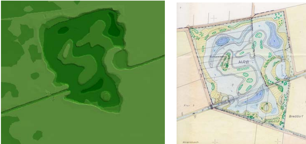
Abbildung 3-25: Lageplan (rechts) und TIN des Regenrückhaltebeckens Rummeldeisbeek (links)
