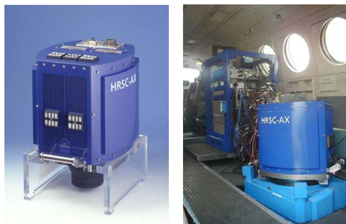
Abbildung 3-6: HRSC-AX Kamera (links) und Einsatz der Kamera im Flugzeug (rechts) [Fotos: DLR, Adlershof]
