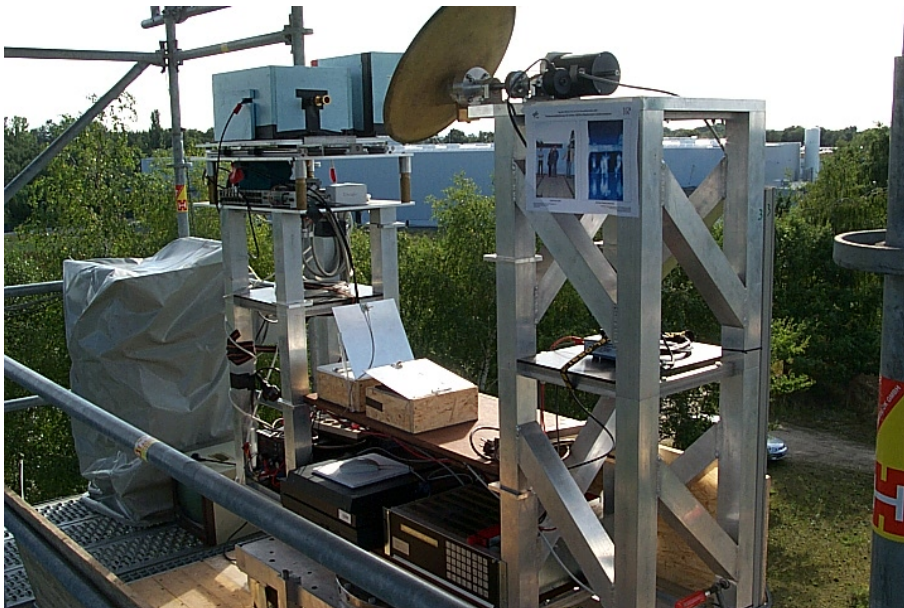
Abbildung 3-12: Modifiziertes Mikrowellen Radiometer (MWR) als Experimentalaufbau der DLR in Oberpfaffenhofen
