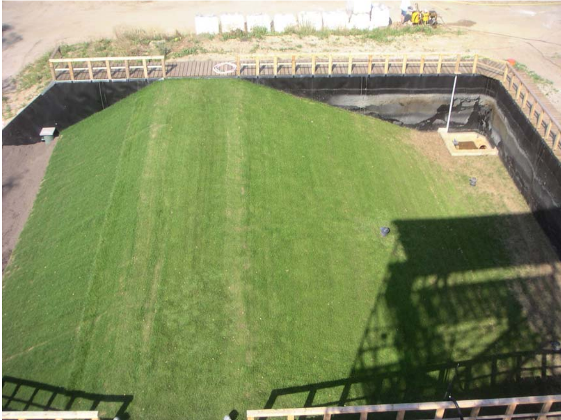
Abbildung 5-6: Ansicht des Deichs nach Beendigung der Versuchsreihe 1 - 09.08.2004 - optimale äußere Bedingungen - keine künstliche Schädigung
