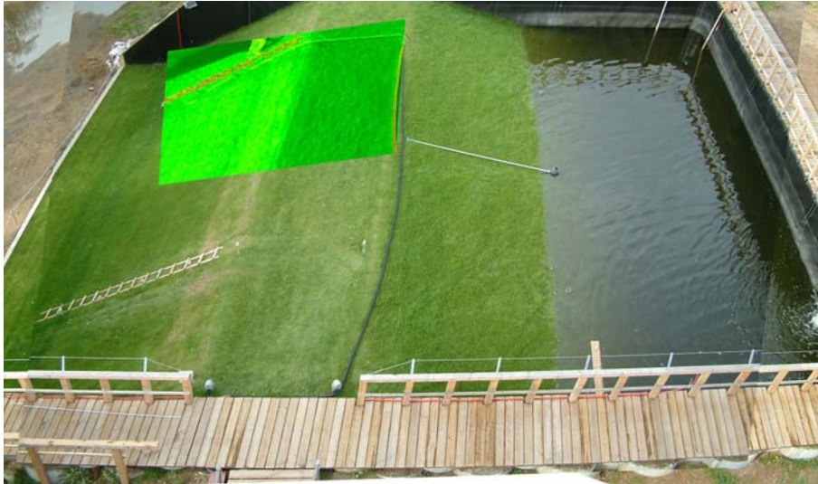
Abbildung 3-11: Thermalinfrarot-Bild einer Messung der ScanDat GmbH vom Labordeich des Franzius-Instituts
