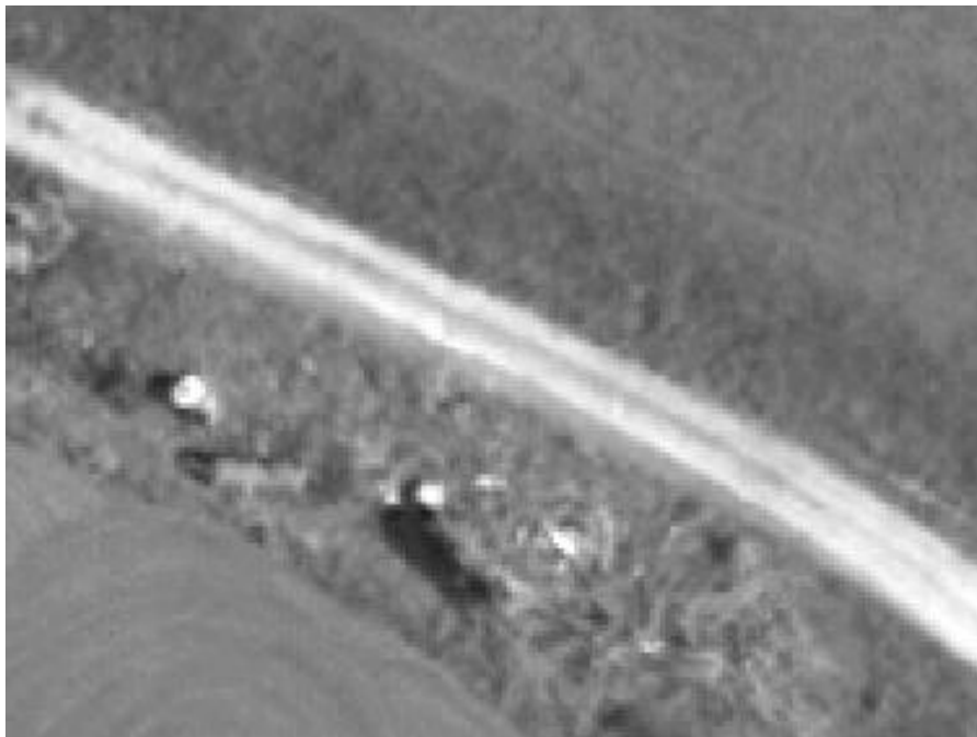
Abbildung 4-31: Mit Schotter befestigter Weg im panchromatischen Bild
