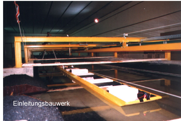
Abb. 6-1: Versuch mit dem Modell des Einleitungsbauwerkes
