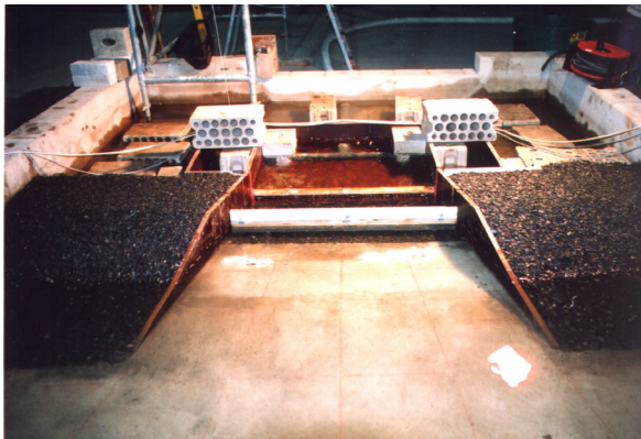
Abb. 5-3: Modell des Einleitungsbauwerkes in der Versuchsanlage Schiffsrinne
