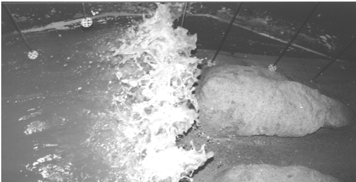
Abb. 4-1: Mechanisches Abtastsystem zur Profilbestimmung (hier nach der Zerstörung der Spundwandvariante)
